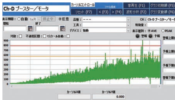
捕捉泵内部变化的特征量
