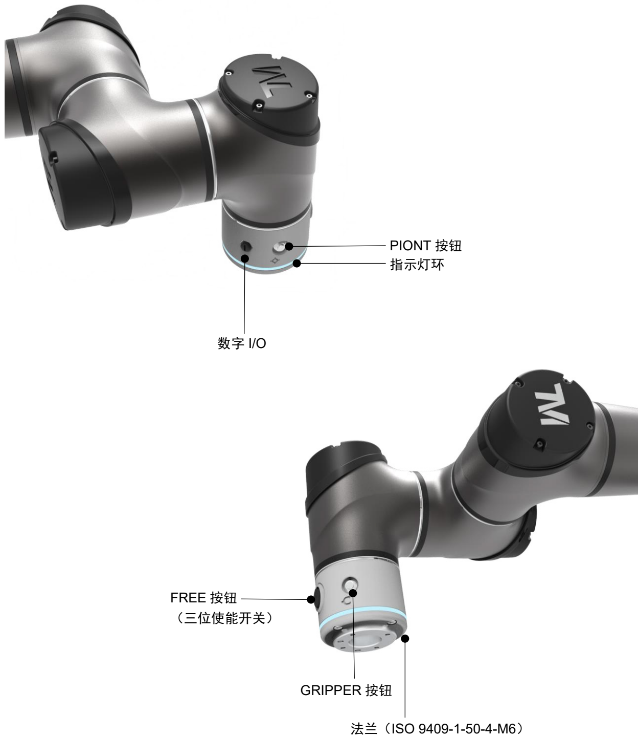
图 19: TM12S-X/TM14S-X 末端模块组件参考图
