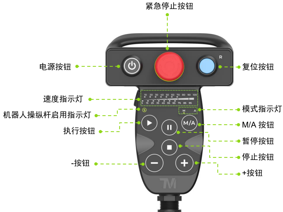
图 23：机器人操纵杆（正面）
