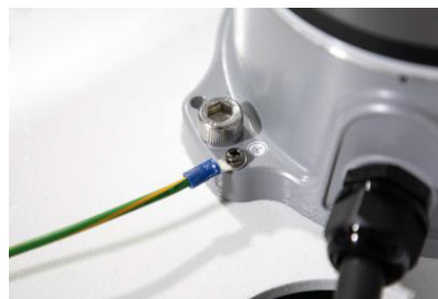
图 17：机器人接地处
